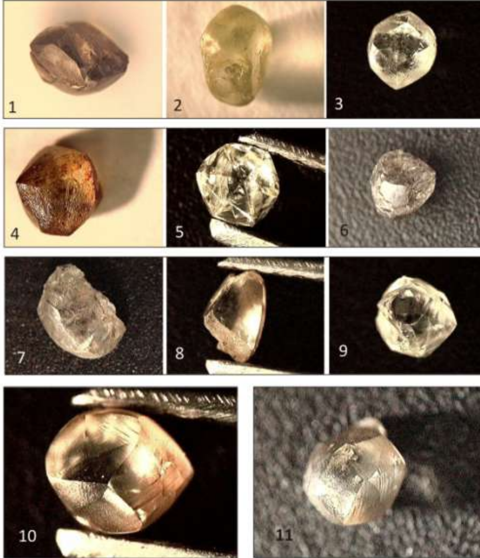
Figura 1 - Amostras de diamantes analisadas em espectroscopia infravermelha. 1 - castanho claro 0,69ct; 2 - verde claro 0,11ct; 3 - incolor 0,20ct; 4 - amarelo-castanho 0,14ct; 5 - Verde claro 0,12ct; 6 - castanho claro 0,11ct; 7 - castanho claro 0,65ct; 8 - castanho claro 0,13ct; 9 - incolor 0,10ct; 10 - castanho escuro 0,10ct; 11 - amarelo 0,20ct.
